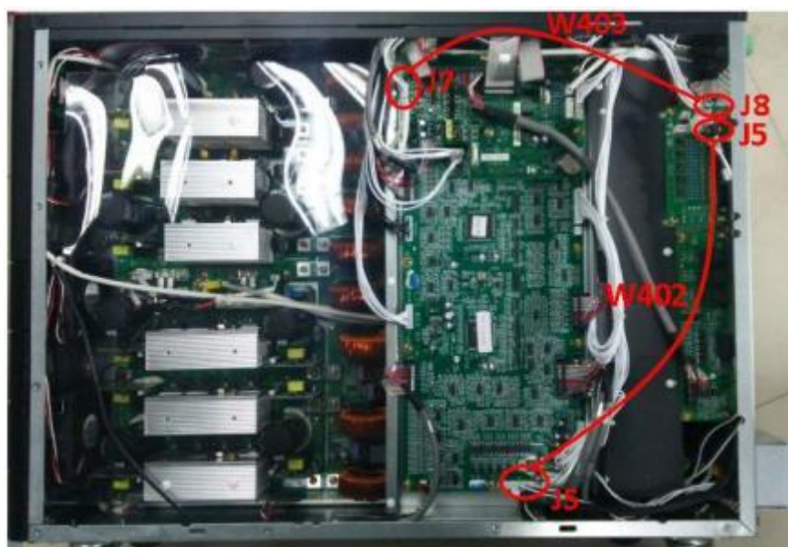
La instalación de placas en paralelo para SAI de 10-15kVA
